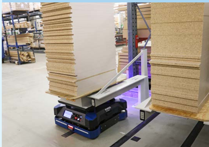
Lo spazio è ristretto. L'AGV è in grado di ruotare sul posto di 360 gradi e di entrare nella stazione buffer con estrema precisione.
