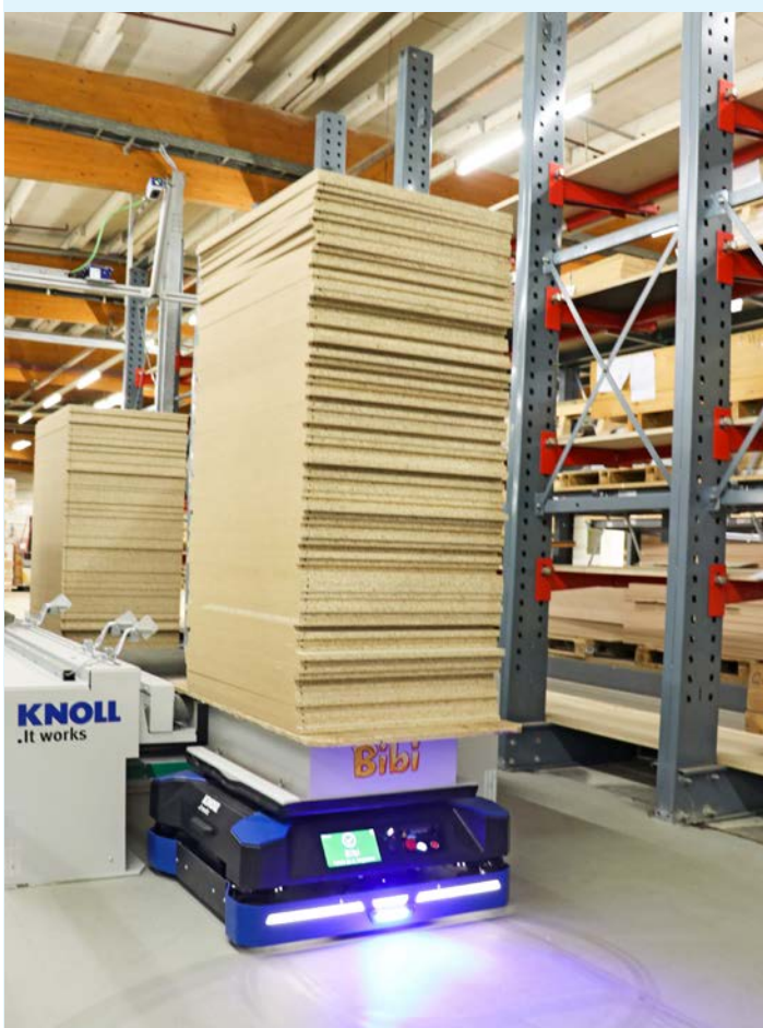
Dopo l'arresto, l'AGV con la pila di pannelli si dirige verso una posizione buffer libera.
