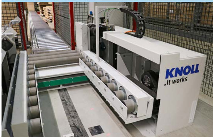
La stazione di ricezione della linea dei zoccoli è caratterizzata da una solida ingegneria meccanica. La piastra di trasporto è appoggiata sulla rulliera corta. Segue l'abbassamento al livello basso della via di trasporto esistente di Staud.
