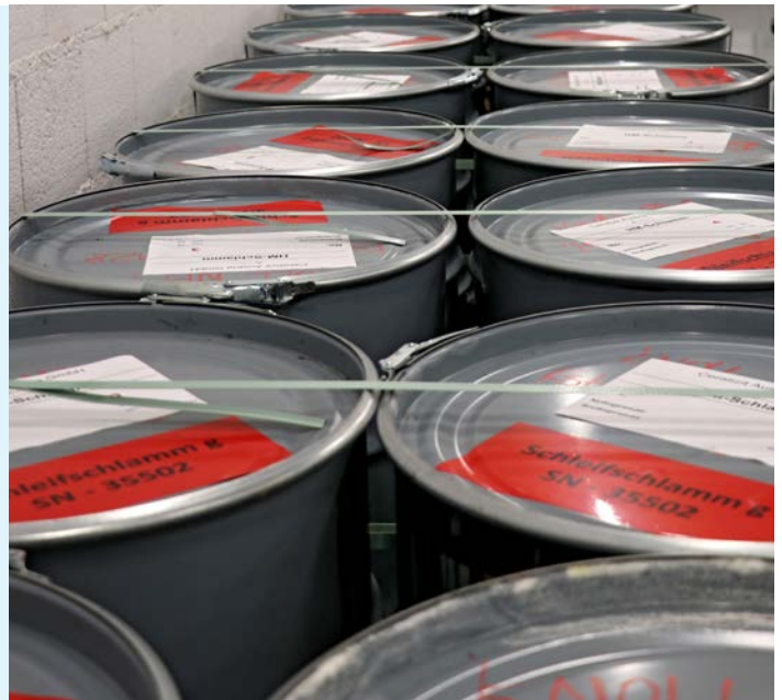
Jedes Entsorgungsfass enthält 400 kg Hartmetallschlamm, der bei einem anderen Unternehmen der CERATIZIT Group aufbereitet und dann in Kreckelmoos wiederverwendet wird.
