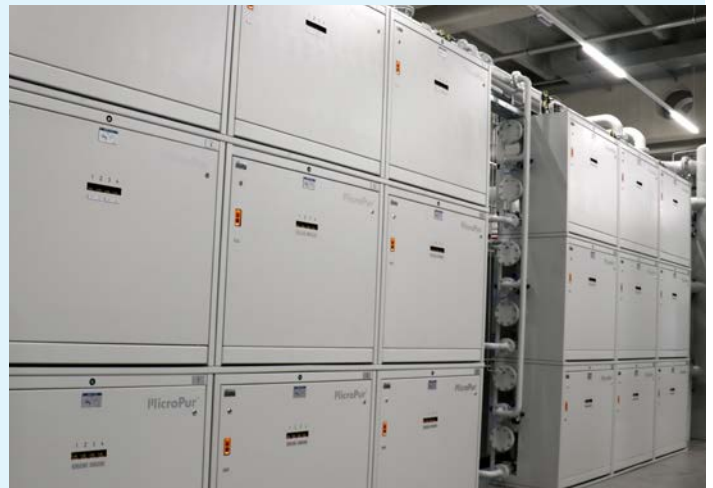
Durch den modularen Aufbau lassen sich zentrale KSS-Reinigungsanlagen mit MicroPur®-Filtern in nahezu beliebiger Größenordnung realisieren. Diese Anlage für wässrige Lösung bietet eine Reinigungskapazität von bis zu 7.500 l/min KSS.
