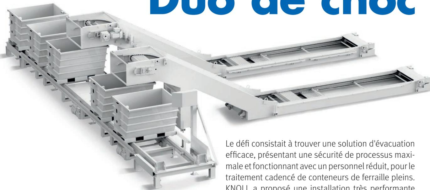
Le défi consistait à trouver une solution d'évacuation efficace, présentant une sécurité de processus maximale et fonctionnant avec un personnel réduit, pour le traitement cadencé de conteneurs de ferraille pleins. KNOLL a proposé une installation très performante associant un convoyeur à plaques et un système de transport automatique.
