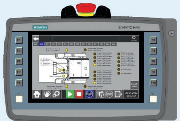
Sensorübersicht über Anlagendetail
