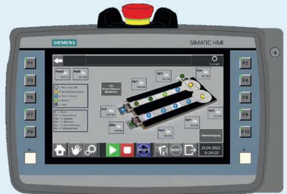
Anlagenübersicht mit Status der Arbeitsplätze
