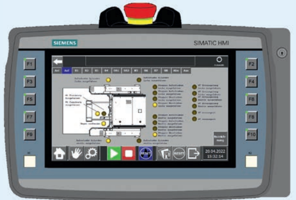
Resumen del sistema de sensores con detalles de cada instalación
