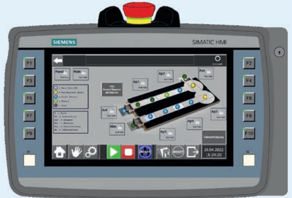
Vista general de la instalación con el estado de los diferentes puestos de trabajo
