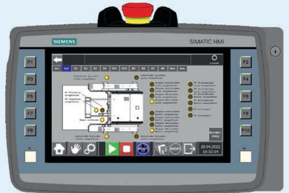
Panoramica dei sensori attraverso dettaglio dell'impianto
