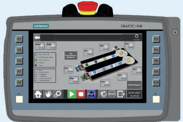
Panoramica dell'impianto con stato delle postazioni di lavoro
