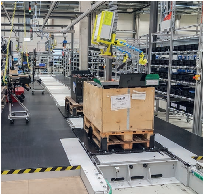
BMZ montiert schwergewichtige Batterien auf KNOLL Transportsystemen vom Typ TS-S und TS-G.
