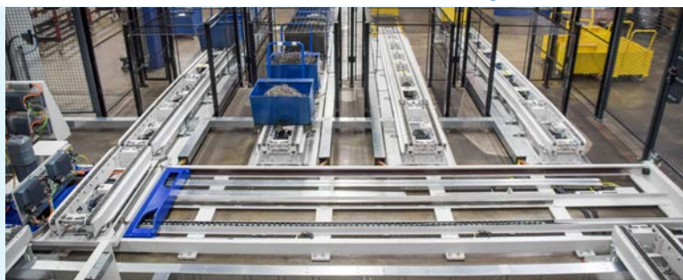
Al final de las zonas de almacenamiento intermedio, los carros portavirutas se transportan hasta los centrifugadores a través de una sección transversal.
