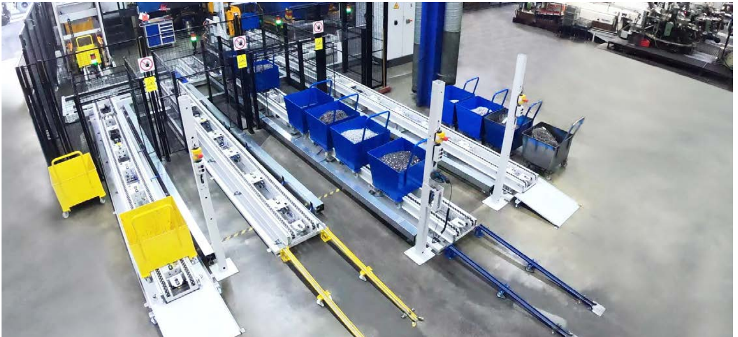
Los centrifugadores de virutas se encuentran al final de los sistemas de transporte de KNOLL. Desde allí, se transportan las virutas desaceitadas hasta los contenedores correspondientes a través de un portal situado a la derecha.
