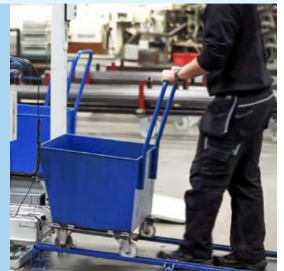
Solo se necesitan de 10 a 15 segundos para introducir un carro portavirutas en el sistema y sacar otro del transportador de salida.
