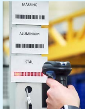
Al cargar el carro portavirutas, el empleado escanea un código de barras correspondiente al material.
