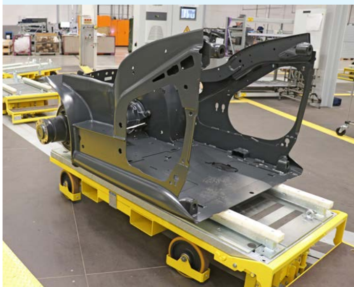
Für die TS-Z-Montagewagen entwickelte KNOLL eine sogenannte Quattro-Lenkung, die Kurvenfahrten ermöglicht.
