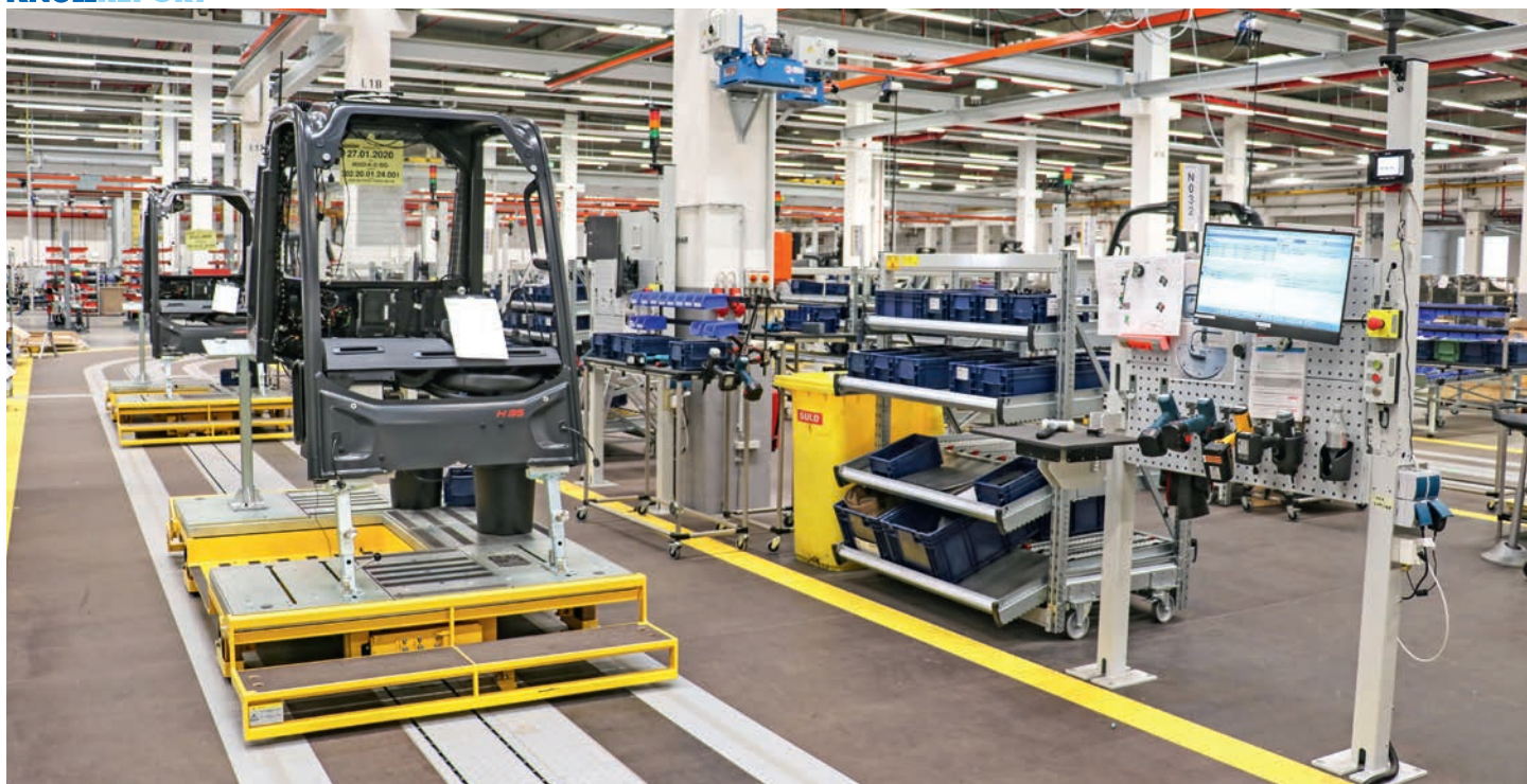
Für eine Staplergeneration, die bei Linde im Aschaffener „Werk 2“ gebaut wird, entwickelte KNOLL zwei Vormontagelinien – für den Rahmen und das Fahrerschutzdach (im Bild).
