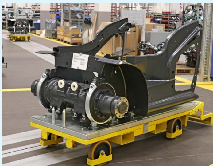
In acht Stationen werden die Rahmenbaugruppen montiert. Jede ist fünf Meter lang und wird in neun Minuten durchfahren.
