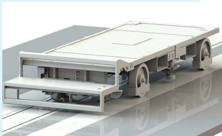
Mittels Stoppereinheit kann der Wagen gesteuert vom Vortrieb der Kette getrennt bzw. wieder eingekoppelt werden. Zusätzlich ist eine Positionsfixierung möglich.
