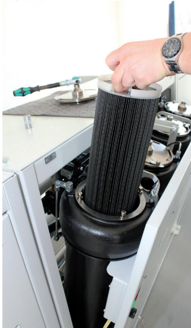
Ein Kernelement der KNOLL Feinstfilter vom Typ MicroPur® sind die Filterpatronen, die regelmäßig prozessparallel rückgespült werden. Bei Verschleiß lassen sie sich einfach, sauber und in kürzester Zeit austauschen.
