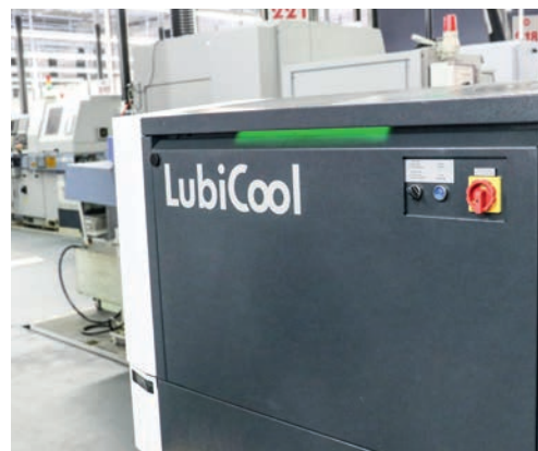
KNOLL Maschinenbau ha reunido en la unidad portátil LubiCool® sus amplios conocimientos sobre el suministro de lubricante refrigerante a alta presión de tornos automáticos.
