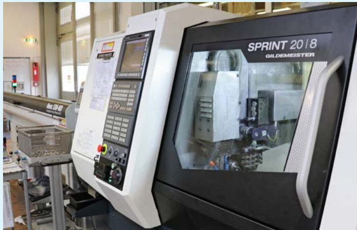
La máquina Sprint 20 de DMG MORI utilizada como torno de cabezal corto: ifm fabrica piezas adaptadoras para sensores de fluidos con esta máquina, que funciona en tres turnos.
