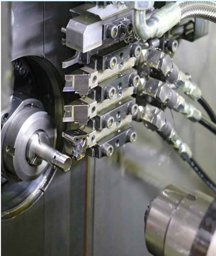
Las hasta ocho salidas conmutables de la unidad de alta presión KNOLL LubiCool®-S garantizan que la máquina-herramienta —en este caso la DMG MORI Sprint 20— reciba el lubricante refrigerante necesario.
