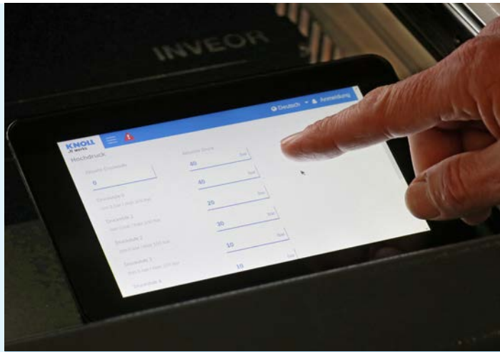
Uno de los aspectos más destacados de toda la serie LubiCool® es su manejo totalmente sencillo e intuitivo. Para ello, KNOLL ha desarrollado el nuevo sistema de control «SmartConnect», que incluye una pequeña pantalla táctil donde el usuario puede ajustar el nivel de presión deseado y otros parámetros.
